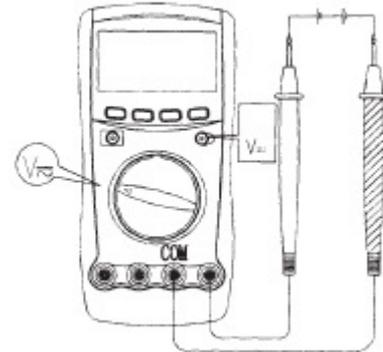
**Внимание:** Не пытайтесь измерять напряжение более 1000 В пост. тока или 750 эфф. Это может привести к повреждению прибора, а также к угрозе поражения электрическим током.
