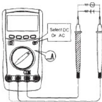
**Внимание:** Запрещается проводить измерения тока в цепях, где напряжение холостого хода превышает  $600 \text{ В}$  относительно земли.
