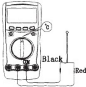
Диапазон измерения температуры:  $-40 \dots +1000 \text{ } ^\circ\text{C}$ .
