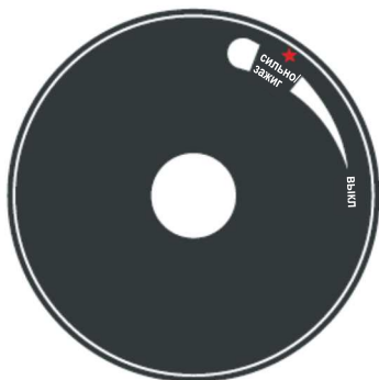
Рис 3. Обозначение положений газового вентиля тепловой пушки
