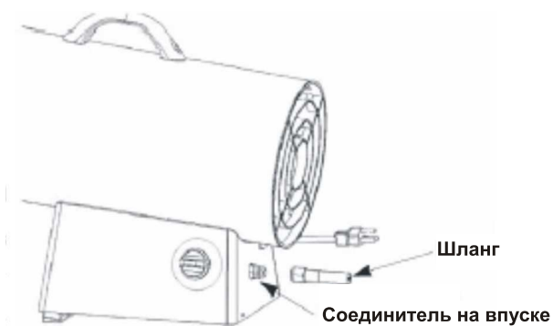
Рис 4. Подключение шланга к выпуску тепловой пушки
