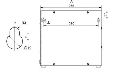
Габаритные и установочные размеры стабилизатора *LIDER PS1200W-30*
