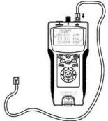
Подсоедините кабель известной длины (например, 100 м) одним концом к главному входу (MAIN). Нажмите кнопку **TEST** для запуска измерения. На дисплее отобразится результат измерения:
