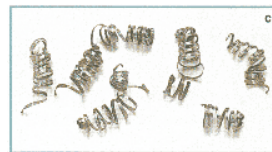
Свободно намотанная (витая) стружка - идеальные условия резания
