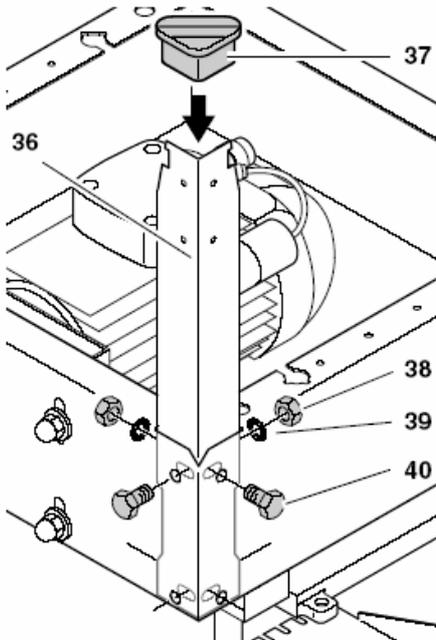
2. Привинтить по углам станка четыре ножки (36):
