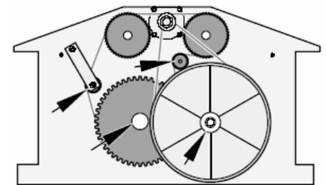
5. Установить крышку механизма и закрепить ее обеими колпачковыми гайками.
