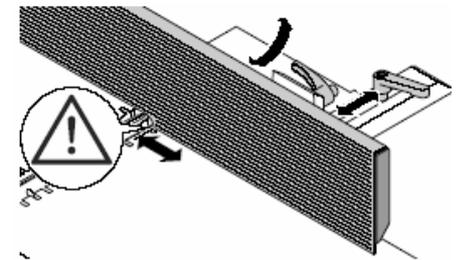
3. При помощи винта (56) с ручкой отрегулируйте толщину снимаемой стружки.
