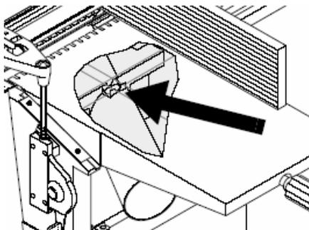
7. Вращением кривошипной рукоятки осторожно поднимать стол для рейсмусования вверх до фиксации кожуха с патрубком для присоединения всасывающего шланга.
