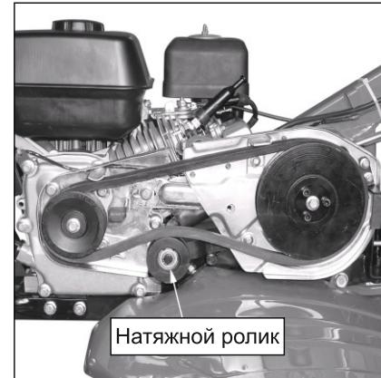
Идеальным натяжением считается, когда надежное вращение ремней обеспечивает заданный режим работы.
