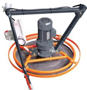
1. Корпус машины с установленными: электродвигателем, редуктором, складной рукояткой, блоком управления, электрической розеткой и затирочным диском рабочего диаметра 610мм.
