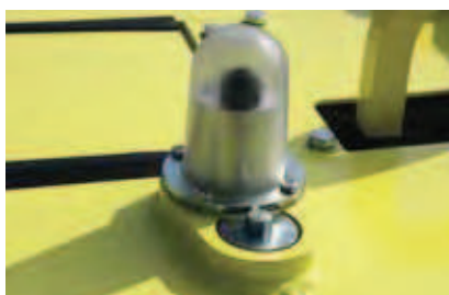
ИК порт приемника сигнала
