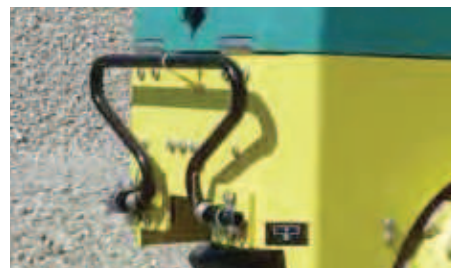
Оptionальная предохранительная штанга с простым механизмом фиксации для транспортировки
