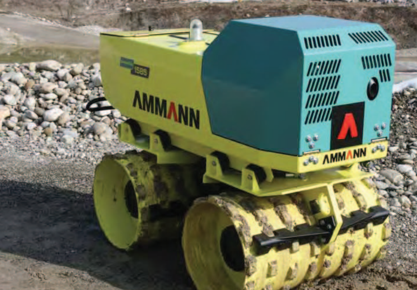
Раммах 1585 с бортовым поворотом
