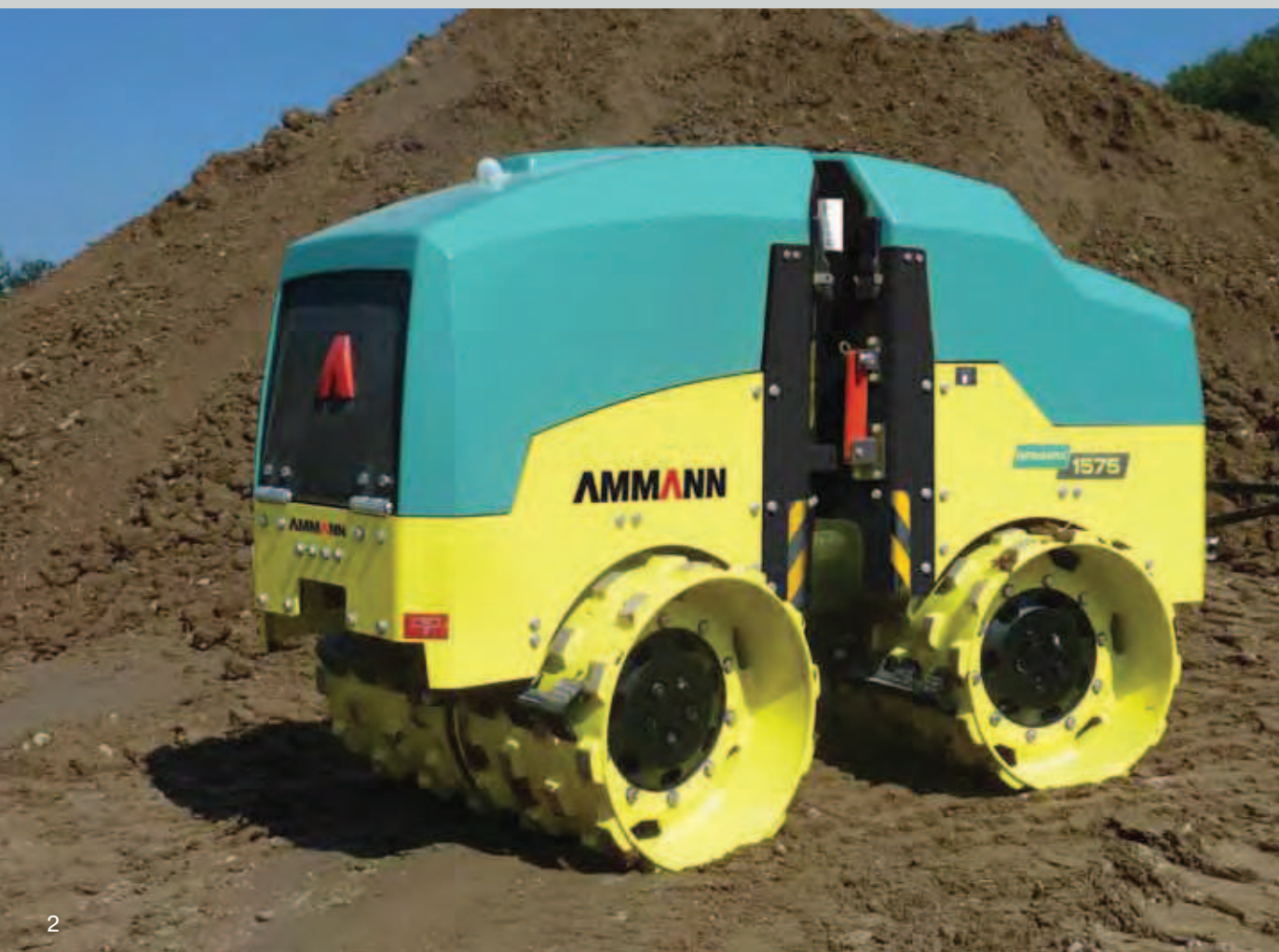
Раммах 1575 с шарнирно-сочлененной рамой
