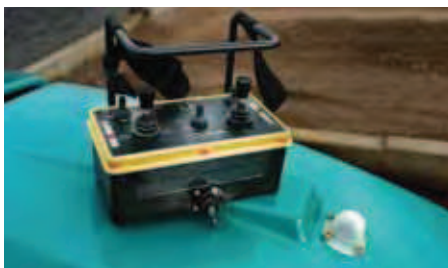
Инфракрасное дистанционное управление от солнечных батарей – без зарядки от сетевых источников питания. Автоматическая подзарядка во время работы
