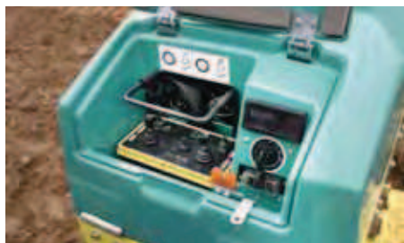
Запирающаяся на замок панель управления с эргономичным размещением элементов управления
