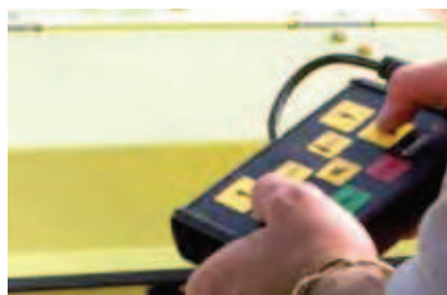
ДУ с гибким скрученным в спираль кабелем
