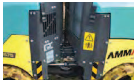
Не требующее обслуживания шарнирное, осцилляционное соединение для идеального контакта с грунтом
